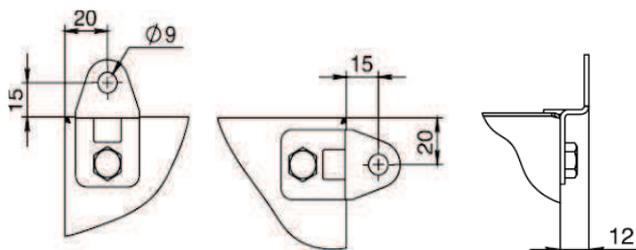
Д. Монтаж распределительной коробки к стене на кронштейнах WB 6 (только для глубины 60 мм).
